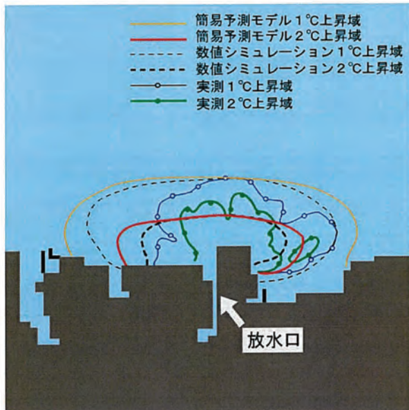
実測および二次元数値シミュレーションと温排水拡散簡易予測モデル 1) による温排水拡散範囲計算結果の比較
